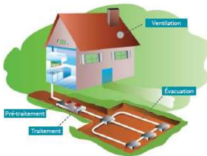
Figure 3 : schéma installation ANC
